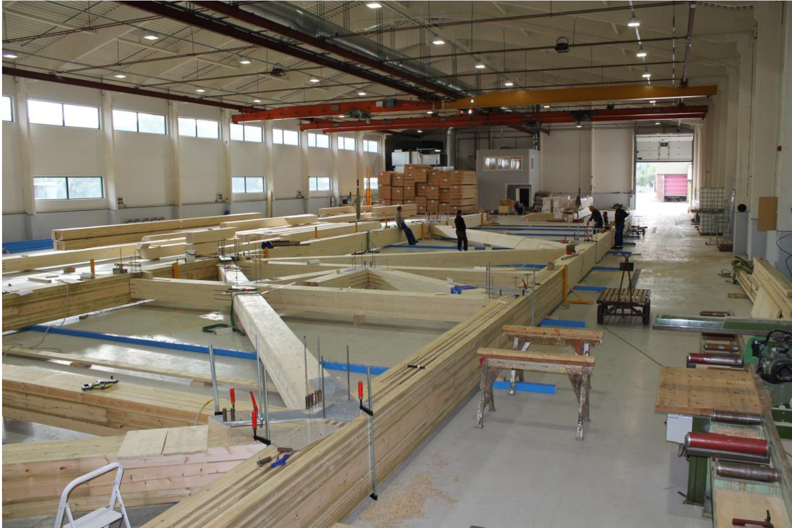
CNC-bearbetade element med millimetertolerans
